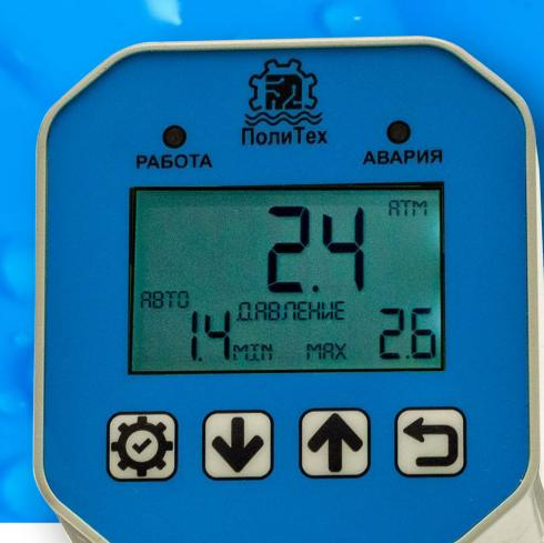
Контроллер для управления работой насоса серии КД-М
